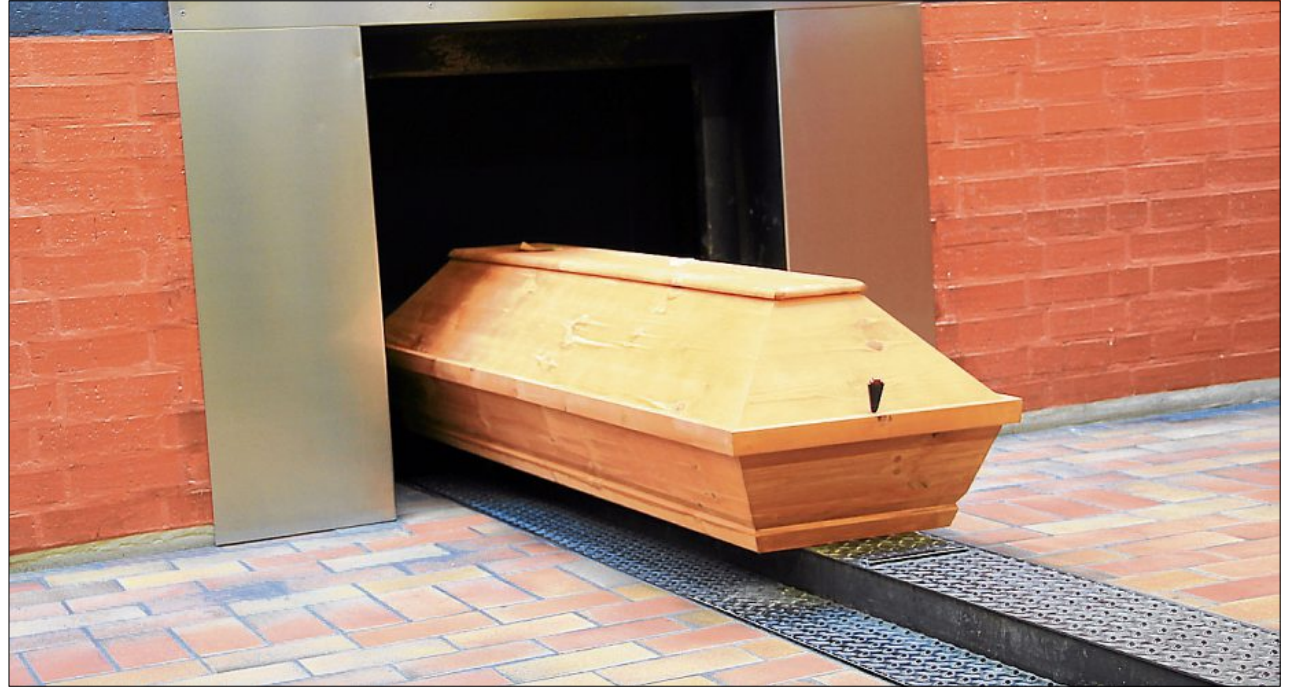
Automatisch fährt der Sarg in einen der beiden Etagenöfen. Rund zweieinhalb Stunden dauert die Einäscherung eines Verstorbenen. (Foto: res)
